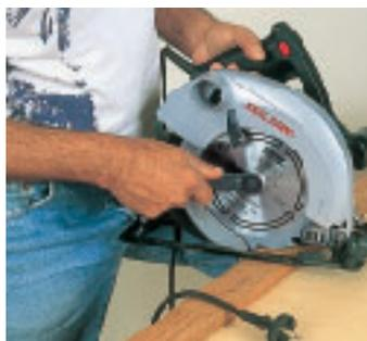
13. Après utilisation, dépeussier la machine, avec un pinceau ou à l'air comprimé.
