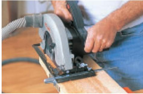
7. Pour réaliser une coupe de faible largeur et parallèle au bord du matériau, utiliser le guide de coupe parallèle.
