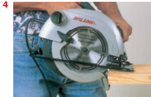
**1. Régler la hauteur de coupe :** une hauteur de dent en plus de l'épaisseur du matériau à couper. Une hauteur de coupe trop importante réduit l'efficacité de la machine.
