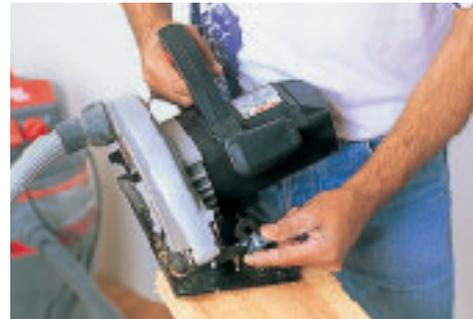
11. La scie circulaire permet aussi de réaliser des rainures : effectuer des sciages successifs côte à côte, en réglant la hauteur de coupe selon la profondeur de la rainure.
